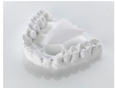
Le nombre de connecteurs entre le bloc de frittage et le bridge doit être égal à 4 au minimum
